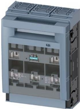
SENTRON, предохранитель-разъединитель 3NP1, 3-пол., NH2, 400 A, для поверхностного и внутреннего монтажа на монтажной панели, плоский контакт, плоскость крышки 70 мм
