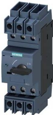
Автоматический выключатель, типоразмер S00 для защиты трансформатора с аprobацией размыкатель цепи UL 489, CSA C22.2 № 5-02 Максимальный расцепитель тока с обратнозависимой выдержкой времени 3,2 A N-расцепитель 65 A Винтовой зажим Стандартная коммутационная способность
