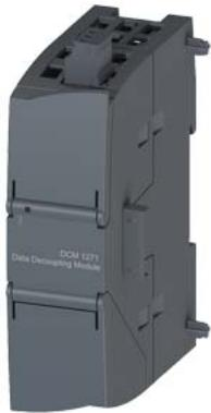
SIMATIC S7-1200, DCM 1271 Развязывающий модуль данных для ведущего устройства AS-i CM 1243-2 Вход: 24 В/30 В DC Выход: 1 x AS-интерфейс, 4 A встроенная защита от перегрузки встр. обнаружение замыкания на землю Сигнальный контакт
