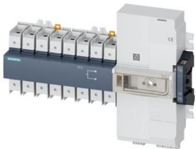
SENTRON, сетевой коммутатор 3КС, с дистанционным управлением, RTSE, 4-пол., Iu: 125 A, Ue AC: 415 В, Ie при AC-33B, при 415 В: 125 A, Ie при AC-23A, при 690 В: 80 A, винтовое и реечное крепление 35 мм, моторизованный привод, правосторонний, длинная поворотная рукоятка, рамочная клемма
