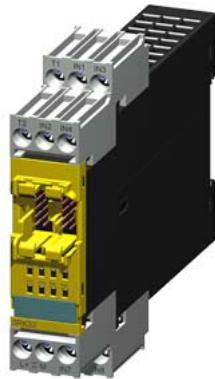
SIRIUS, блок расширения 3RK32 для модульной системы безопасности 3RK3 4/8 Оу-ЦВх, 24 В DC возможность параметрирования на MSS ES Установочная ширина 22,5 мм Винтовые зажимы до SIL3 (МЭК 61508) до уровня производительности Е (ISO 13849-1) без соединительного кабеля
