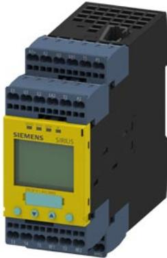
Предохранительное устройство SIRIUS безопасно-ориентир. Устройство контроля скорости вращения 110–240 В AC/DC, 45 мм Пружинная клемма FK без задержки: 2 HO FK с задержкой: 0 МК: 2 электр. Версия NAMUR Автозапуск/ручной запуск Главное устройство макс. доступн. PL согласно EN 13849-1: e макс. доступн. SIL согласно МЭК 61508: 3
