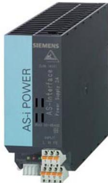
Питание AS-i 3 A 120/230 В AC Блок питания AS-интерфейса, IP20 Вход: 120 В/230 В AC Выход: AS-i, 3 A (30 В DC), IP20 со встроенным обнаружением замыкания на землю, со встроенной защитой от перегрузки с разъединением данных AS-i
