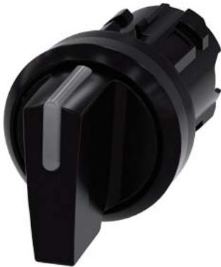
Рычажный переключатель с подсветкой, 22 мм, кругл., пластмасса, цвет: черный, рычаг короткий, 3 положения переключателя I>O-II, нажатием на кнопку против часовой стрелки, с фиксацией по часовой стрелке, угол переключения 2 x 45°, 10:30 ч/12 ч/13:30 ч
