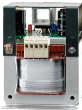
Блок питания; фазы: 1; PN (кВт): 0,36; UPRI (В): 400–230(240)–115(120); USEC (В DC): 24; ISEC (А DC): 15/18 (60/40 °C); F (Гц): 50–60; группа перекл./экран. эфф.: II 0/0; кл. защиты: I; TA/кл. изол.: 60/В; W (%): 5; IP00; подключение: винтовой зажим; монтаж: винты; EN 61558-2-6, EN 61131-2 >Изолирующий трансформатор<
