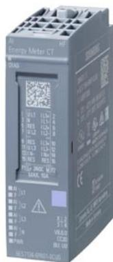
SIMATIC ET 200SP, модуль аналогового ввода - электрический счётчик ~480 В, AI Energy Meter 480V CT HF, с улучшенными функциями, для токовых трансформаторов 1A/5A, с функциями анализа сети, для установки на базовый блок типа U0, диагностика канала
