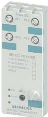
Компактный модуль AS-i K60, аналоговый 4 ABx, IP67 4 x вход, Сопротивление PT100, Ni100, 0–600 Ом для 4-проводных датчиков 4 x розетка M12 Монтажная панель 3RK1901-0CA00 заказывается отдельно
