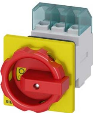
SENTRON, выключатель-разъединитель 3LD, аварийный выключатель, 3- пол., Iu: 32 A, рабочая мощность/ при AC-23A при 400 В: 11,5 кВт, фронтальное крепление, поворотный привод, цвет: красный/желтый, крепление центральной гайкой 22,5 мм для рукоятки
