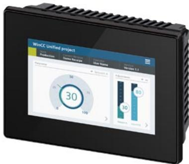
SIMATIC HMI, панель MTP700 серии Unified Comfort, без логотипа Siemens, сенсорное управление, широкоформатный TFT-дисплей с диагональю 7", 16 млн цветов, интерфейс PROFINET, настройка в среде разработки WinCC Unified Comfort V16, содержит ПО с открытым кодом.
