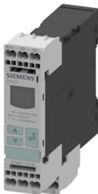
Цифровое реле контроля Контроль напряжения, 22,5 мм от 10 до 600 В AC/DC Превышение и недостижение 24–240 В AC/DC DC и AC, 50–60 Гц Задержка импульсных помех 0,1–20 с 1 переключающий контакт, контроль рампы торможения (с датчиком или без него)
