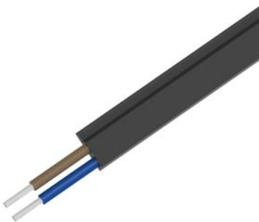
Плоский провод AS-i, профилированн. для внешнего вспомогательного напряжения 24 В цвет: черный, ТПЭ, маслостойк. Специальное исполнение согласно классу UL 2, 2 x 1,5 мм<sup>2</sup>, 100 м состоит из провода 100 м
