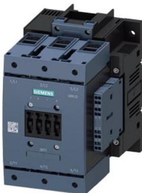
Силовой контактор, AC-3 115 А, 55 кВт/400 В AC (50–60 Гц)/режим работы по DC UC 440–480 В Выключатель вспомогательных цепей справа 3RH1921-2DE11, 3-полюсн., типоразмер S6, с рамочными клеммами Привод: стандартный Винтовой зажим катушки
