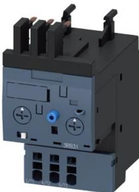
Реле перегрузки 4–16 А электронн. для защиты двигателя Типоразмер S00, класс 5–30 Для установки на контакторах Главная цепь: пружинная клемма Вспомогательная цепь: пружинная клемма Ручной/автоматический сброс Внутреннее обнаружение замыкания на землю
