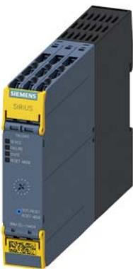
Реверсивный пускатель Failsafe, 3RM1, 500 В, 0–0,12 кВт, 0,1–0,5 А, 24 В DC, винтовой зажим
