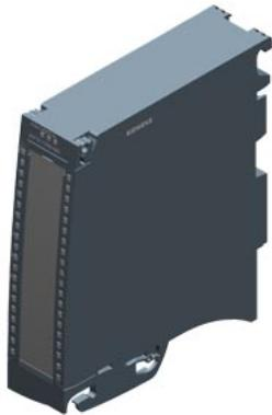
SIMATIC S7-1500, модуль аналоговых входов, AI 8xU/I/R/RTD BA, разрешение 16 бит, точность 0.5%, 8 каналов в группе из 8, напряжение общей точки =4 В, диагностика, прерывания процесса, включая вводной элемент, зажим и клемму заземления, фронтальный соединитель должен быть заказан отдельно
