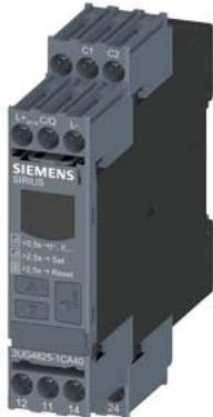
Цифровое реле контроля для контроля тока утечки с дифференциальным преобразователем тока 3UL23 для IO-Link Диапазон настройки 0,03–40 А отдельно для порога предупреждения и значения отключения Задержка запуска и срабатывания 0–999,9 с Гистерезис отключения до 50 % Гистерезис предупреждения 5 % фиксирует. Ширина 22,5 мм, 2 переключающих контакта контроль торможения (с датчиком или без него) винтовой зажим
