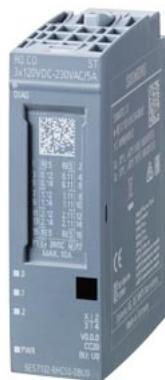
SIMATIC ET 200SP, модуль релейных выходов, RQ CO 3x 120V DC..230VAC/5A ST, 3 перекидных контакта (CO), изолированные контакты, упаковка из 1 шт., для установки на базовые блоки типа U0, цветовой код CC20, замещающее значение, диагностика модуля для напряжения питания
