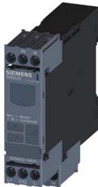
Цифровое реле контроля Контроль тока, 22,5 мм для IO-Link 0,05–10,0 А AC/DC Повышенный и пониженный ток Коэффициент масштабирования преобразователя Гистерезис 0,01–5,0 А Время задержки пуска Время задержки срабатывания 1 переключающий контакт, винтовой зажим
