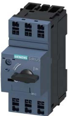
Автоматический выключатель, типоразмер S00 для защиты трансформатора Максимальный расцепитель тока с обратнозависимой выдержкой времени 7–10 A N-расцепитель 208 A Подключение на пружинных клеммах Стандартная коммутационная способность
