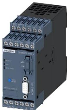
Базовое устройство SIMOCODE pro V MR, MODBUS RTU-интерфейс 57,6 кбит/с, RS-485, 4 Вх/3 Вых свободно параметрируемые US: 110–240 В AC/DC, вход для подключения термистора, моностабильные релейные выходы, расширяется за счет модулей расширения
