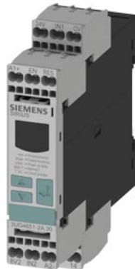
Цифровое реле контроля Устройство контроля скорости вращения от 0,1 до 2200 об/мин Превышение и недостижение Напряжение питания: 24 В AC/DC DC и AC, 50–60 Гц без гальванической развязки к измерительному контуру Задержка пуска 1–900 с Задержка срабатывания от 0,1 до 99,9 с Гистерезис от 0,1 до 99 об/мин 1 переключающий контакт, контроль рампы торможения (с датчиком или без него) Пружинные клеммы
