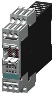
SIRIUS, блок расширения 3RK33 для модульной системы безопасности 3RK3 8 ЦВх, 24 В DC возможность параметрирования на MSS ES Установочная ширина 22,5 мм Винтовые зажимы без соединительного кабеля
