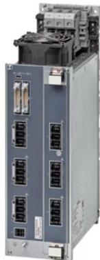
SIPLUS HCS4300, модуль POM4320 Highend для панельного монтажа (IEC). Силовой выходной модуль для монтажа на задней панели шкафа управления. С 6 выходами каждый макс. 15360 Вт (для режима работы полуволнового управления: в зависимости от пускового тока ограничения нагрузки до макс. 6400 Вт)
