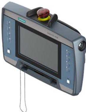
SIMATIC HMI, мобильная панель KTP700F Mobile Arctic, (расширенный диапазон рабочих температур), TFT-дисплей с диагональю 7.0" и разрешением 800x 480 точек, 16 млн цветов, кнопочное и сенсорное управление, 8 функциональных клавиш, 1x интерфейс PROFINET/Industrial Ethernet, 1x слот для multimedia card, 1x USB, 1x сенсорное перо, ключ-переключатель, кнопка подтверждения, кнопка аварийного останова, настройка в среде разработки начиная с WinCC Comfort V15 SP1
