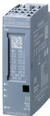
SIMATIC ET 200SP, модуль релейных выходов, RQ COni 3x120VDC..230VAC/5A ST, 3 перекидных контакта (CO), неизолированные контакты, упаковка из 1 шт., для установки на базовые блоки типа U0, цветовой код CC20, замещающее значение, диагностика модуля для напряжения питания
