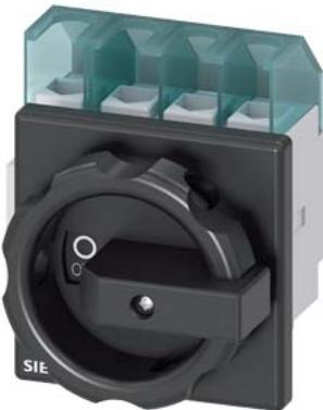
SENTRON, выключатель-разъединитель 3LD, главный выключатель, 4-пол., Iu: 32 A, рабочая мощность/ при AC-23A при 400 В: 11,5 кВт, фронтальное крепление, поворотный привод, цвет: черный, 4-винтовое крепление рукоятки
