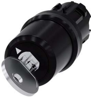
замковый переключатель Siemens, 22 мм, цилиндрической формы, пластмасса, номер замка SSG10, с 2 ключами, 2 коммутационных положения О-I, с фиксацией, угол коммутации 90°, 10:30 ч/13:30 ч, извлечение ключа в положении О
