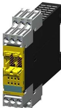
SIRIUS, блок расширения 3RK32 для модульной системы безопасности 3RK3 2/4 Оу-ЦВх, 1/2 Оу-РелВых, 24 В DC/1 А возможность параметрирования на MSS ES Установочная ширина 22,5 мм Винтовые зажимы до SIL3 (МЭК 61508) до уровня производительности E (ISO 13849-1) без соединительного кабеля
