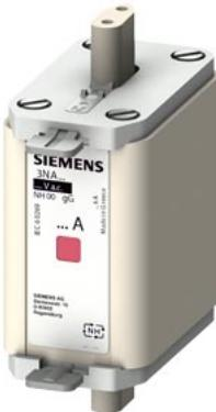
вставка предохранителя NH, NH00, In: 160 A, gG, Un AC: 400 В, комб. индикат., изолированные монт. выступы
