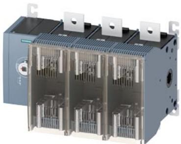
выключатель-разъединитель с предохранителем, 630А, типоразм. 5, 3-пол. для предохранителей NH разм. 3 и 2 фронтальный привод, левый базовое устройство без рукоятки плоский контакт , особый модуль SIVACON
