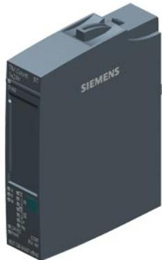
SIMATIC ET 200SP, технологический модуль счёта TM count 1x 24 V, 1 канал для 24-вольтовых инкрементных или импульсных энкодеров, 3 дискретных входа (DI), 2 дискретных выхода (DQ), для установки на базовый блок BU типа A0, количество в упаковке: 1 штука
