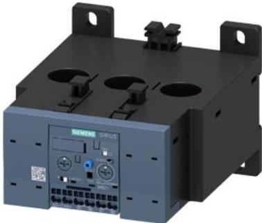
Реле перегрузки 50–200 А для защиты двигателя Типоразмер S6, класс 5–30E Для установки на контакторах/автономной установки Главная цепь: шинный трансформатор тока. Вспомогательная цепь: пружинная клемма Ручной/автоматический сброс Внутреннее обнаружение замыкания на землю
