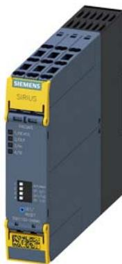
Предохранительное устройство SIRIUS Базовое устройство серии Advanced 3 электронные разблокирующие цепи 1 электронная сигнальная цепь  $U_s = 24$  В DC Пружинная клемма (Push-In)
