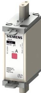
вставка предохранителя NH, NH000, In: 32 A, gG, Un AC: 400 В, комб.
