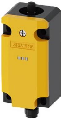
Базовый выключатель без приводной головки металлический корпус, согласно EN 50041 ASafe встроено Состояние AS-i: 1:F-IN1, 2:F-IN2 3:AS-i/FAULT Контакты зависимого действия 2 Н3 со штекером M12 4-пол. Канал 1 на Н3, канал 2 на Н3
