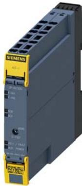
Модуль ASafe SlimLine Compact SC17.5F digital safety 2 Oy-ЦВх/2 ЦВых, IP20 2 x вход для механических датчиков 2 x стандартный выход 24 В DC Питание выхода с возможностью переключения пружинные клеммы Установочная ширина 17,5 мм
