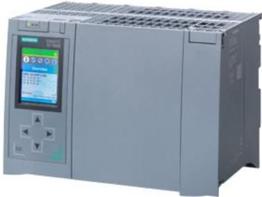
SIMATIC S7-1500H, ЦПУ CPU 1518HF-4 PN, центральный процессор для стандартных и отказобезопасных задач с 9 МБ рабочей памяти и 60 МБ памяти данных, 1-ый интерфейс: PROFINET RT с 2-портовым коммутатором, 2-ой интерфейс: PROFINET, 3-ий интерфейс: PROFINET, 4-ый/5-ый интерфейс: H-SYNC, для работы необходима карта памяти SIMATIC MC
