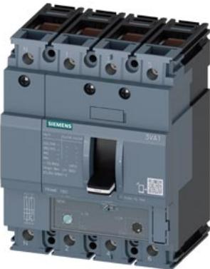
авт. выключатель 3VA1 IEC типоразмер 160 класс коммутационной способности M  $I_{cu} = 55 \text{ kA}$  @ 415 В 4-пол., защита оборудования TM240, ATAM,  $I_n = 50 \text{ A}$  защита от перегрузки  $I_r = 35 \dots 50 \text{ A}$  защита от коротких замыканий  $I_i = 5 \dots 10 \times I_n$  нейтральный проводник не защищен клеммное соединение
