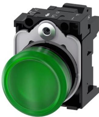
Индикаторная лампа, 22 мм, кругл., пластмасса, цвет: зеленый, линза, гладкая, с держателем, светодиодный модуль, со встроенным светодиодом, 230 В AC, пружинная клемма
