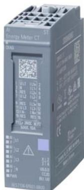
SIMATIC ET 200SP, модуль аналогового ввода - электрический счётчик ~480 В, AI Energy Meter 480V CT ST, со стандартными функциями, для токовых трансформаторов 1А/5А, для установки на базовый блок типа U0, диагностика канала
