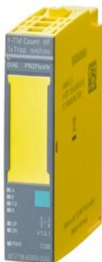
SIMATIC ET 200SP, отказобезопасный технологический модуль F-TM Count 1x1Vpp sin/cos HF, - модуль счёта, PROFIsafe, 1-канальный, для инкрементальных энкодеров, sin/cos 1 Vpp, упаковка из 1 шт., для установки на базовые блоки типа A0 \*\*\*\*\*
