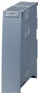
SIMATIC S7-1500, модуль дискретных входов, DI 64xDC 24V SNK/SRC BA, 64 канала в группах по 16, входная задержка типично 3,2 мс., вход типа 3 (IEC 61131); вход sinking/sourcing. модуль шириной 35 мм, кабели и клеммные блоки заказываются отдельно, как принадлежности
