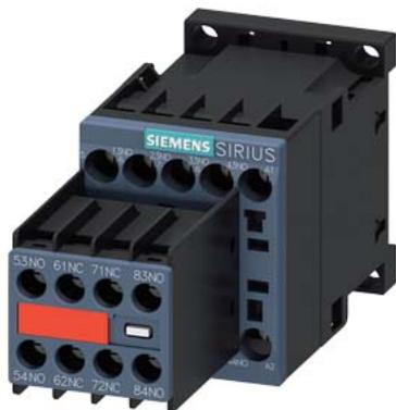
вспомогательный контактор, 6 НО + 2 НЗ, 220 В АС, 50 Гц, 240 В, 60 Гц, типоразмер S00, винтовой зажим, выключатель вспомогательных цепей, неразъемный
