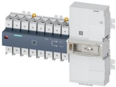
SENTRON, ATE, сетевой переключатель 3КС, авт., ATSE, 4- пол., Iu: 125 A, Ue AC: 415 В, Ie при AC-33В, при 415 В: 125 A, Ie при AC-23A, при 690 В: 80 A, винтовое и реечное крепление 35 мм, моторизованный привод, правосторонний, длинная поворотная рукоятка, рамочная клемма
