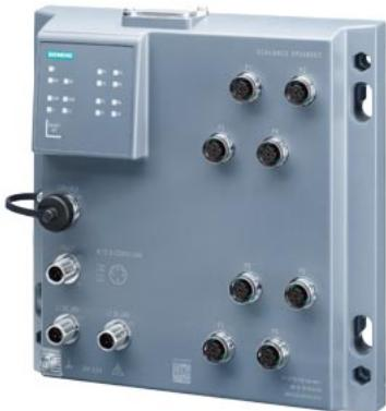
SCALANCE XP208EEC промышленный управляемый IE коммутатор, соответствие ж.д. стандартам (EN 50155, EN 45545); 8x электрических M12 портов 10/100 Мбит, защита IP65, светодиодная индикация, диагностический выход, резервированное питание 24В, PROFINET IO-устройство, управление сетью, поддержка резервированного кольца, пылезащитные колпачки для разъемов, электронное руководство на CD, поддержка C-plug модуля (приобретается отдельно).
