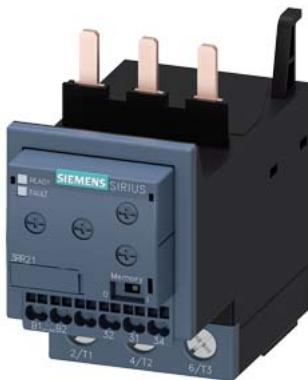
Реле контроля, установка на контактор 3RT2, типоразмер S2 Basic, аналоговая регулировка Мониторинг кажущегося тока 8–80 А, 50–60 Гц, 2-фазн. Питание 24–240 В AC/DC 1 переключающий контакт Контроль на Превышение и недостижение Выпадение фазы Обрыв провода контроль рампы торможения (с или без датчика) Задержка пуска 0–60 с Отфильтровывание импульсных помех 0–30 с Гистерезис срабатывания 6 % Пружинные клеммы
